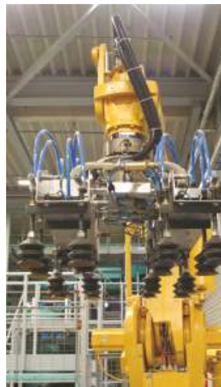
Greifer des modular aufgebauten Depalletier-Roboters im DHL-Verteilzentrum Bielefeld. Bild: BIBA
